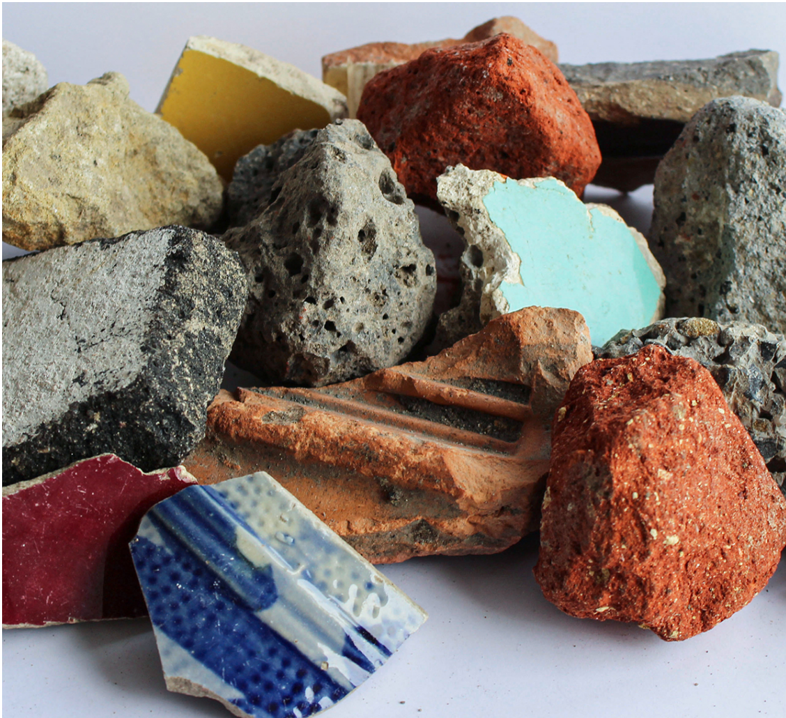
© BauCycle - verschiedene Bauschuttfraktionen , Bild: © Fraunhofer UMSICHT
