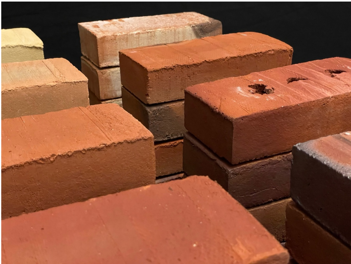
Variation von Backsteinen hergestellt aus zwei Tonsorten in unterschiedlichen Mischverhältnissen und Bearbeitungsmethoden Bild: Zürcher Ziegeleien
