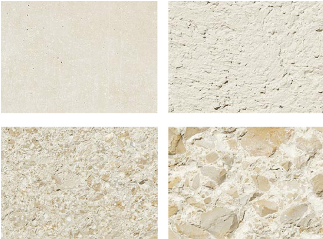
Ammocret-Kalksteinbeton schalungsroh, abgerieben, gestockt, gespitzt
