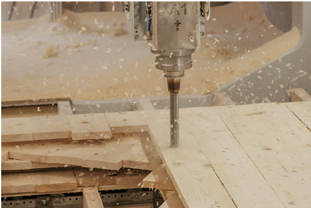
Arbeit am Vollholz-System von KÜNG Holzbau AG, Bild: KÜNG Holzbau AG
