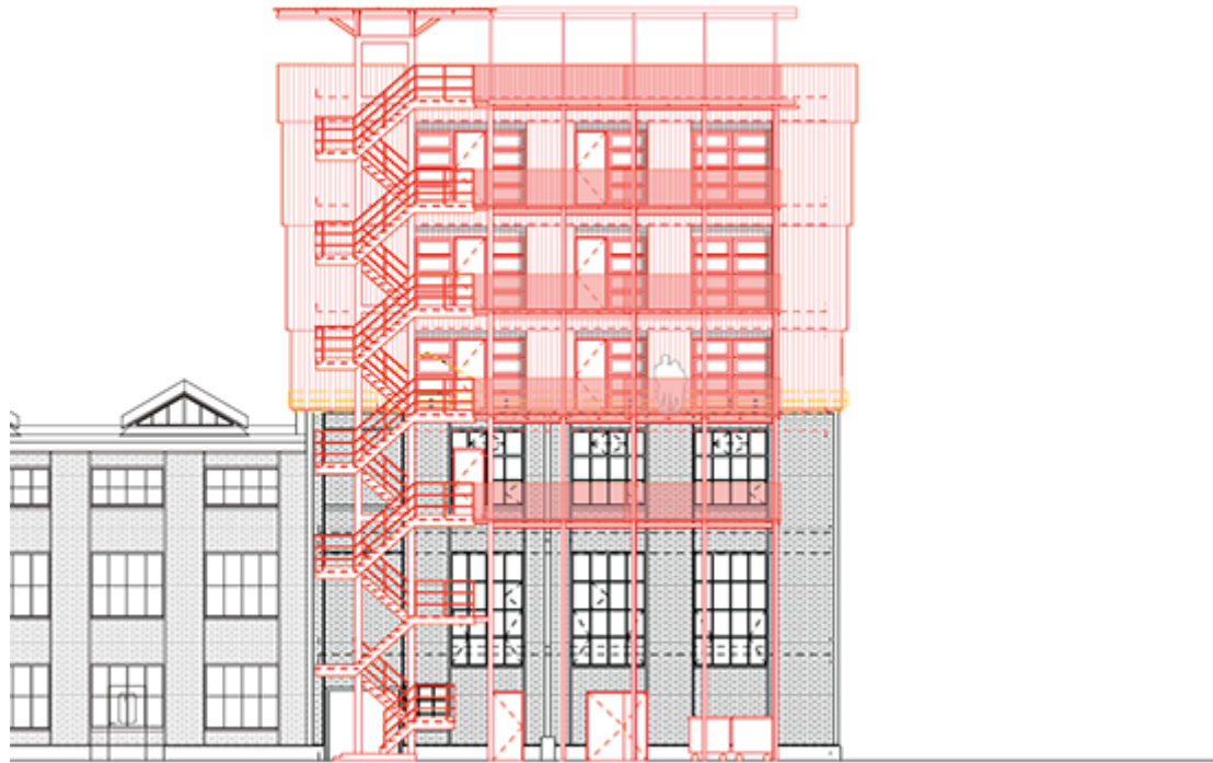
Ansicht Kopfbau Halle 118 mit Aufstockung, Winterthur, baubüro in situ
