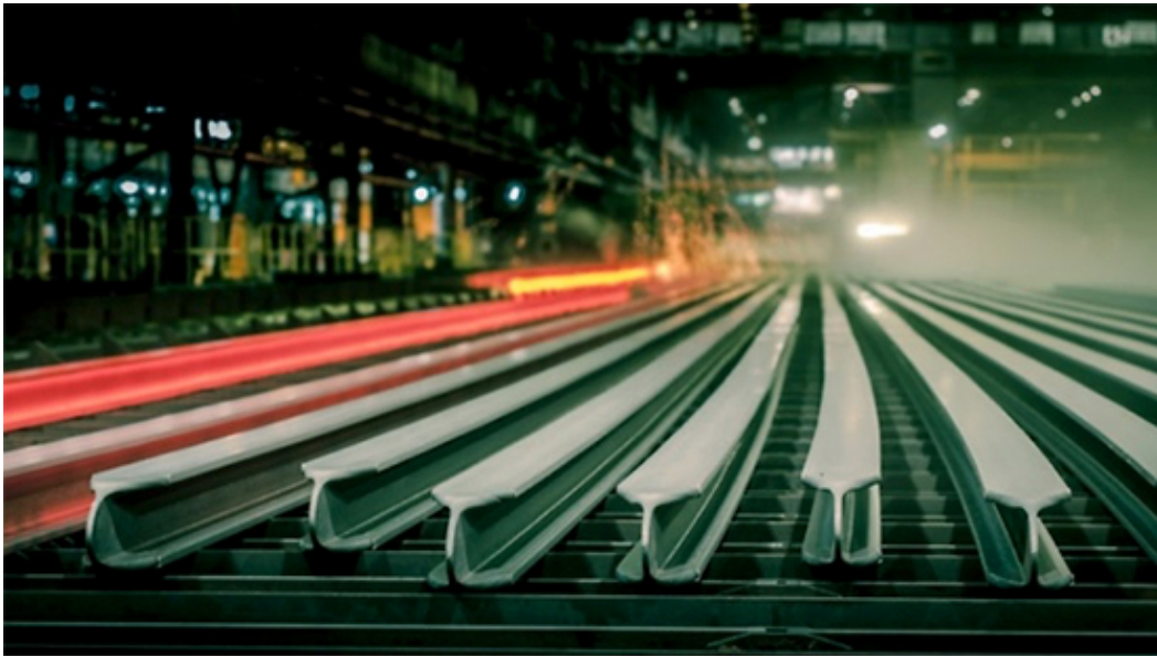
Neue Stahlprofile verlassen die Walzstrasse bei rund 950°C Foto: Stahlwerk Thüringen
