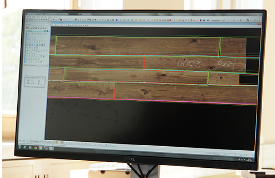
der Verlegeplan wird vom Computer generiert
