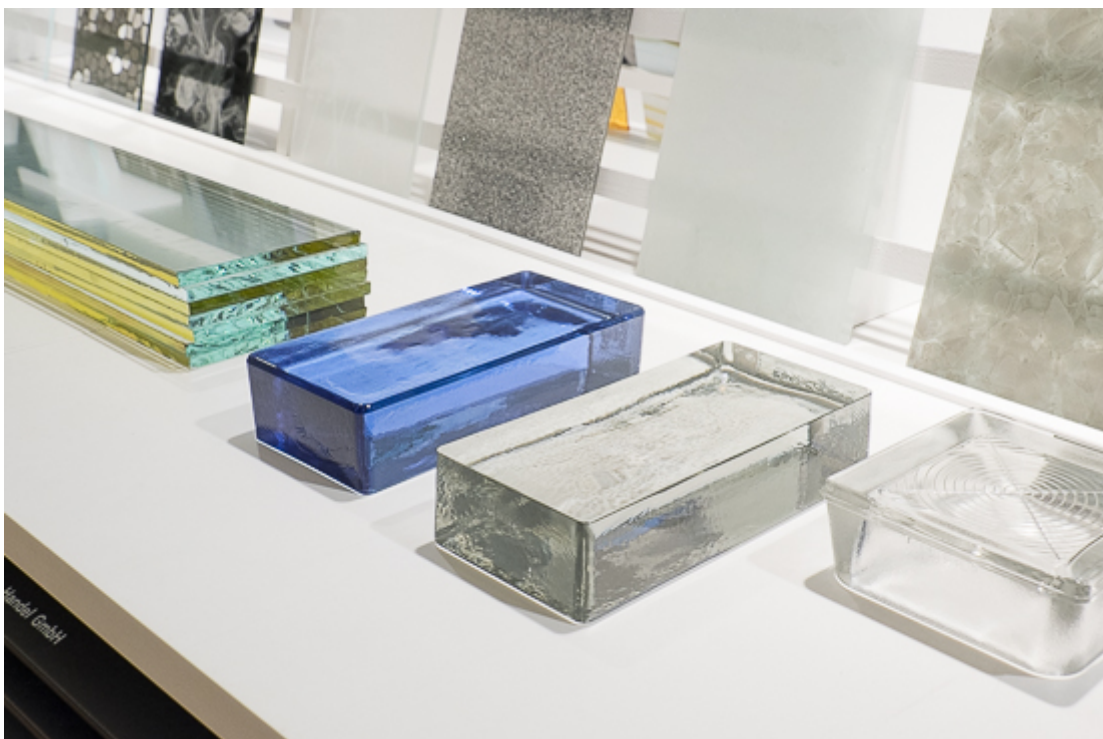
Geschichtetes Glas, Glasziegel und Betonglas als konstruktive Elemente
