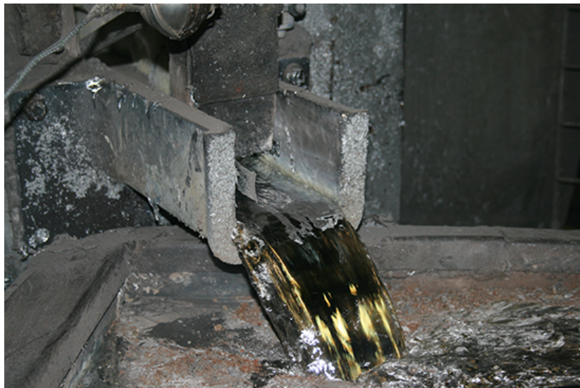
Schmelzen des Zinkerzes
