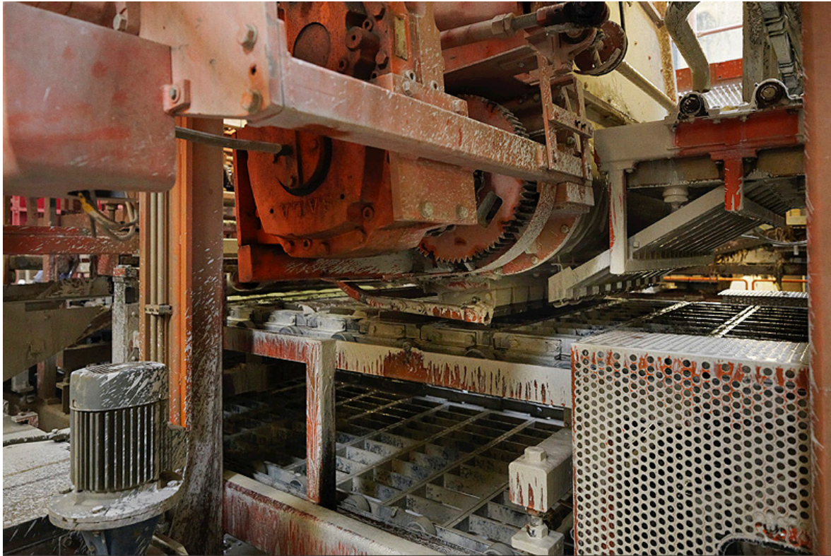
Selbst entworfene und gebaute Anlagen von Petersen Tegel zur Nachahmung manueller Herstellung
