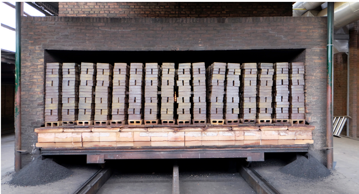
Nach drei Tagen im Kohlebrandofen sind die Ziegelsteine fertig gebrannt
