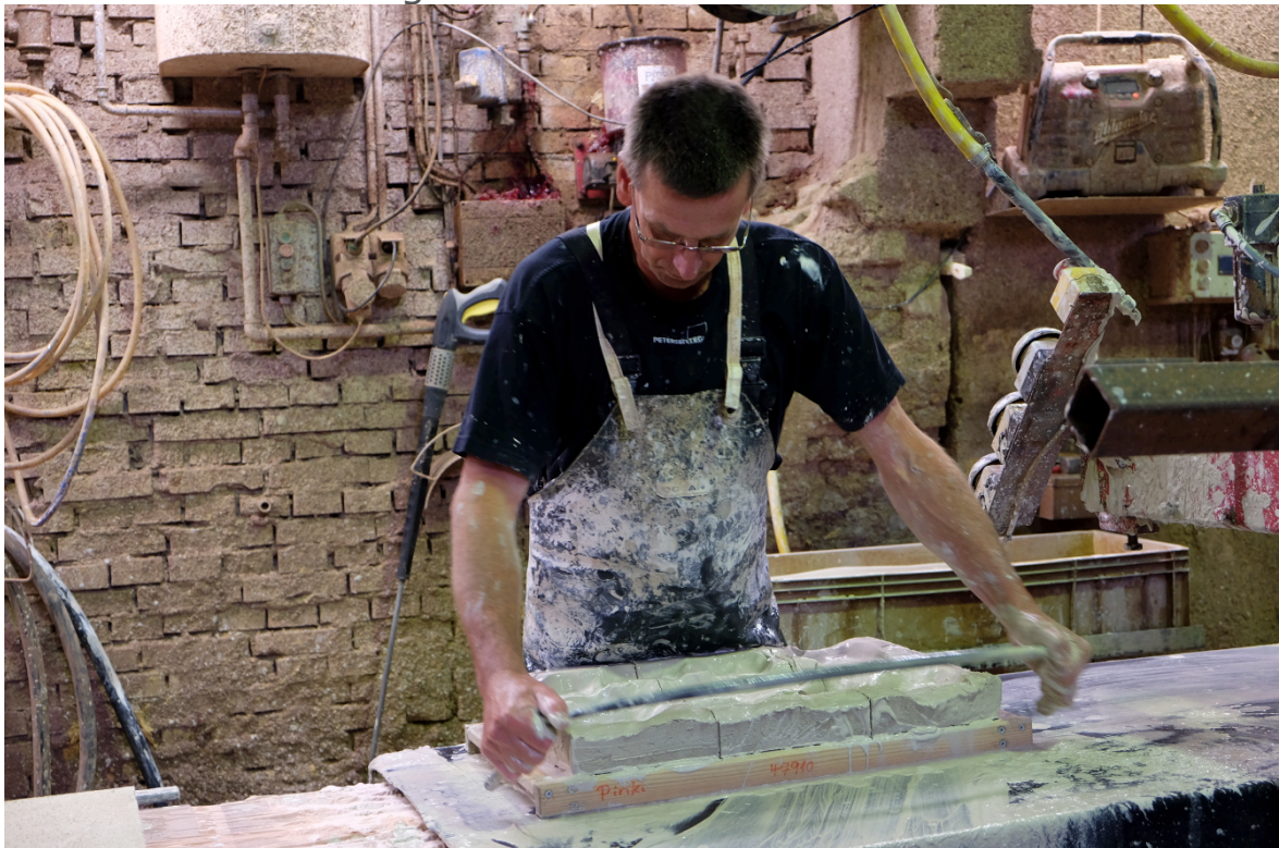
Ziegelsteinproduktion in Handarbeit bei Petersen Tegel.
