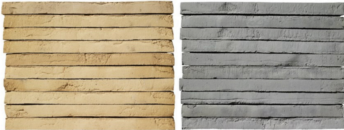
Ziegel vor und nach dem Dämpfprozess: links Kolumba K31, rechts Komumba K51
