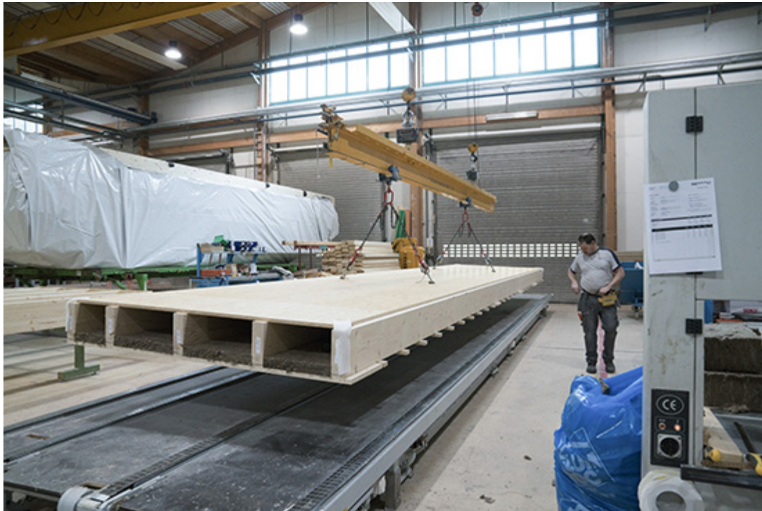
Produktion der Deckenelemente, Renggli AG
