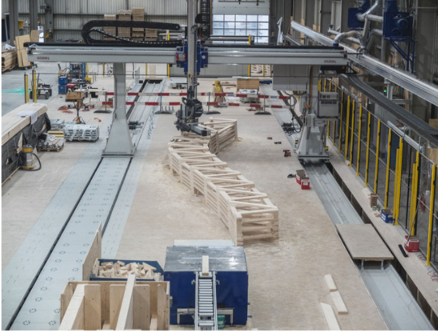
Produktion der Träger 2015 in Stein/AG, Spannweite 15 Meter.
