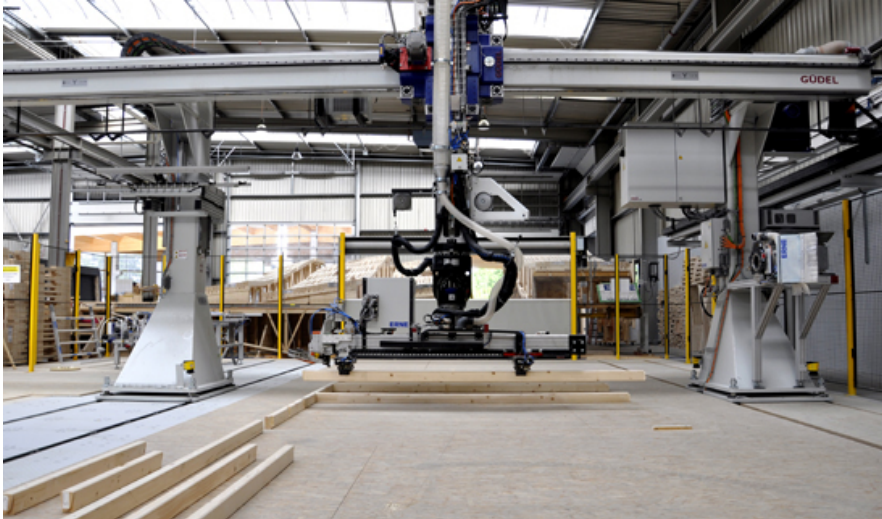
Portalroboter, Fabrikation in Stein/AG.
