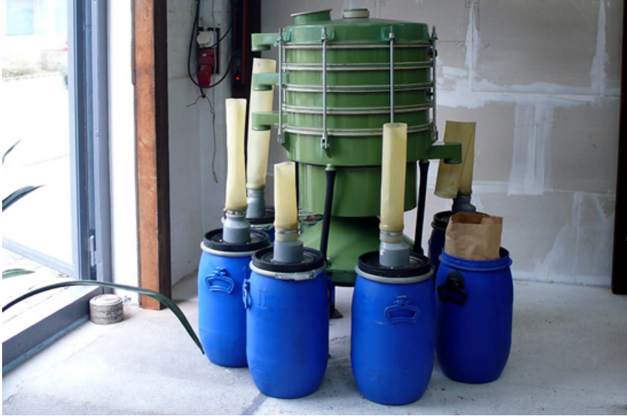
Eine Entwicklung aus eigenem Haus, die "Glassand Sortiermaschine".
