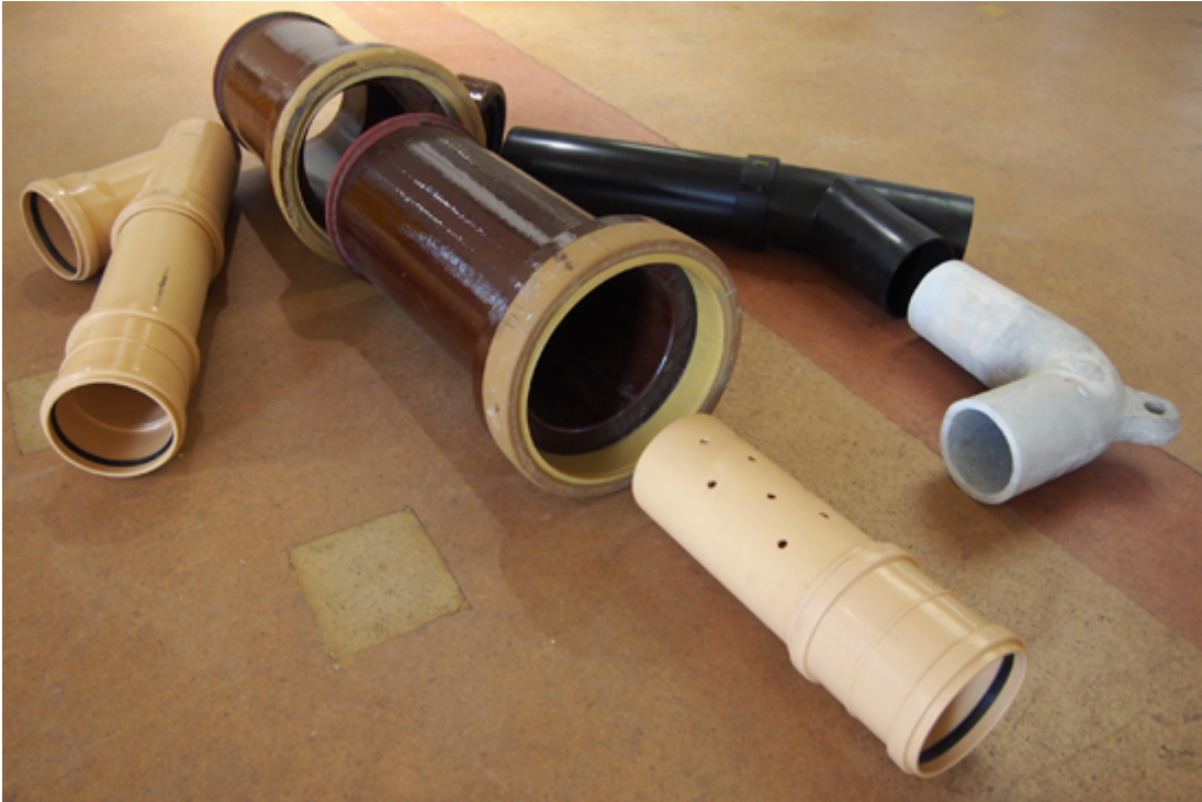
Im Uhrzeigersinn von links: PP Abzweiger, Steinzeug Muffe, PE Abzweiger, Eternit Sturzgefälle und PP Drainage
