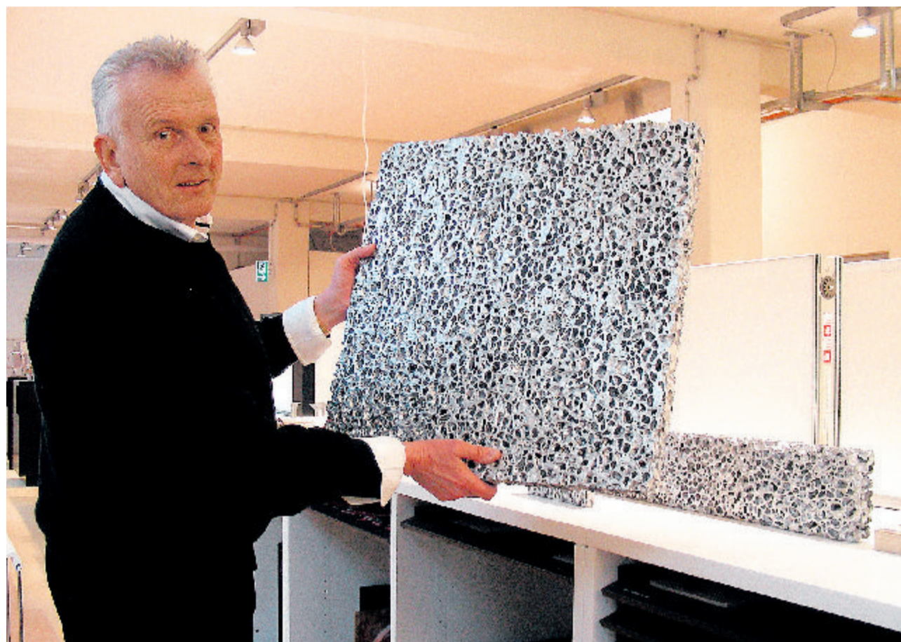
Werner K. Rüeegger, Geschäftsleiter der Baumuster-Centrale, mit einem Beispiel für geschäumtes Aluminium. Bild: Alfred Borter
