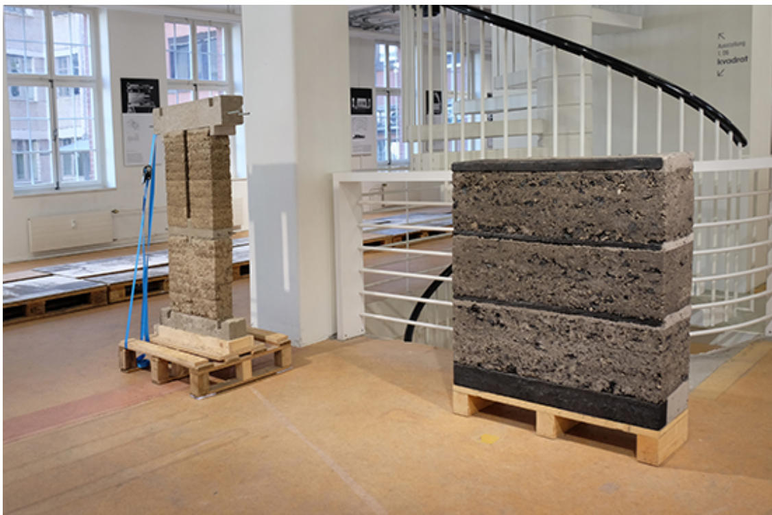
Modell für das Mock-Up in St. Gallen / Stampflehm-mauer mit schwarzem Sand und verkohlten Brettern
