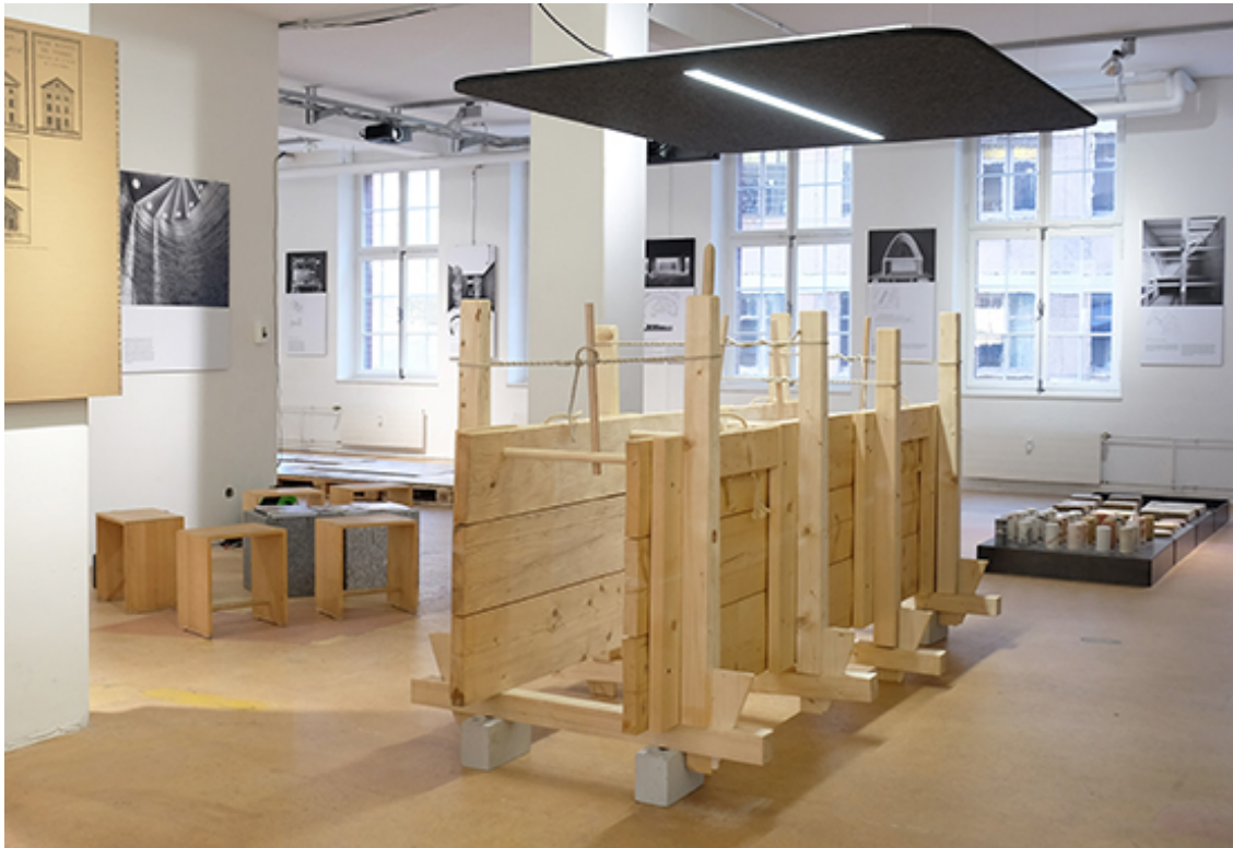
Nachbildung: François Cointeraux (1740-1830) Schalung für Stampflehm, später für Beton adaptiert
