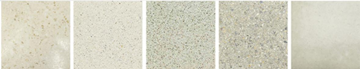
Betonoberflächenmuster in der SBCZ: Geschliffen, sandgestrahlt, gestockt, scharriert oder schalungsglatt
