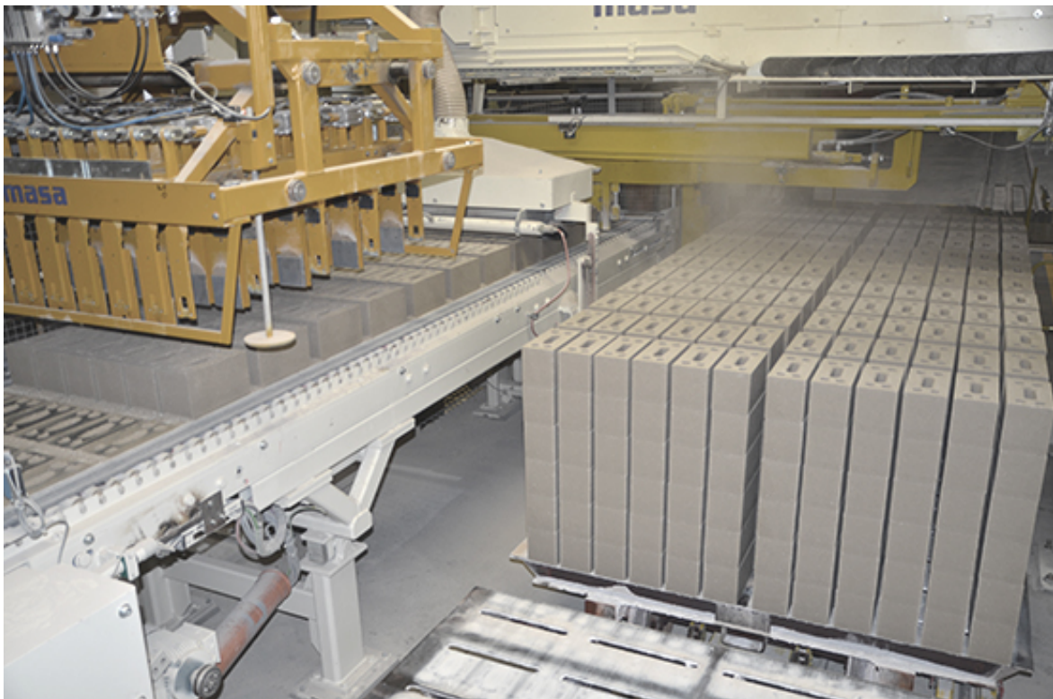
Herstellung des Kalksandsteins, Hunziker Kalksandstein, Werk Brugg
