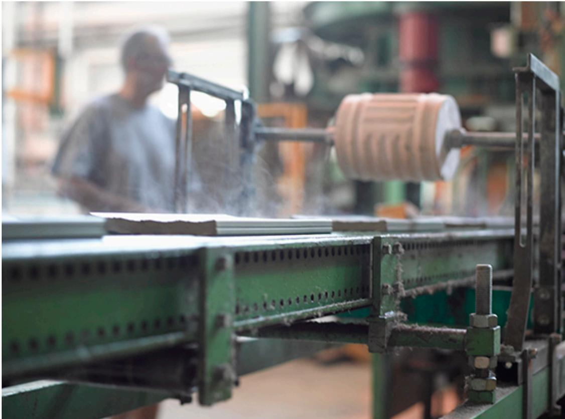
Maschinelle Oberflächenbearbeitung von Tonziegeln
